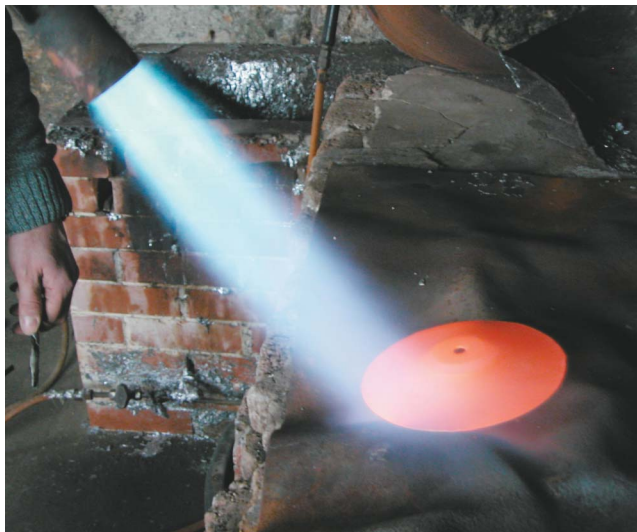
Flamme an: Ab und zu muss der Schallbecher erhitzt werden, damit er nicht reißt. Wenn er per Flamme weich gemacht wurde und wieder abgekühlt ist, geht's weiter
