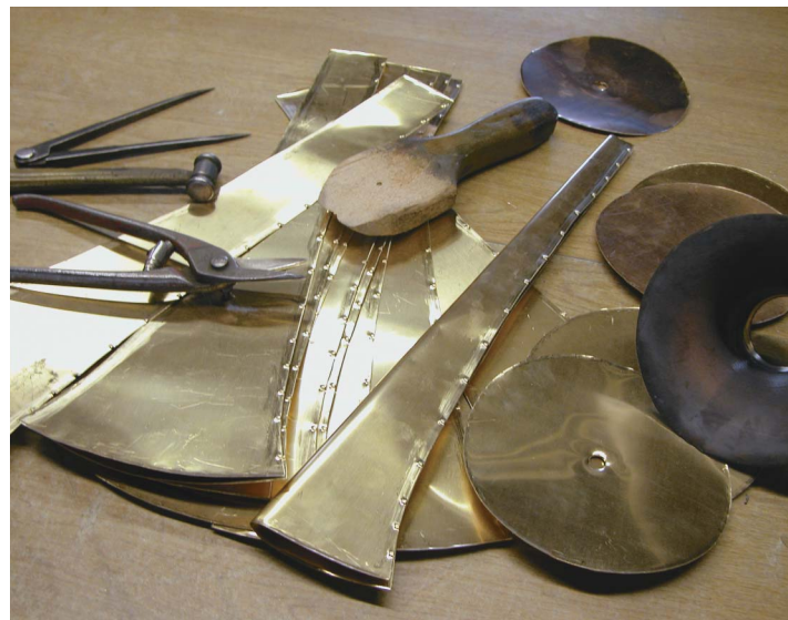
Setzkasten: Auf Maß geschnittenes Messing für das Fürst-Pless-Horn. Hieraus werden Schallbecher, Schallstück und Anstoß geformt
