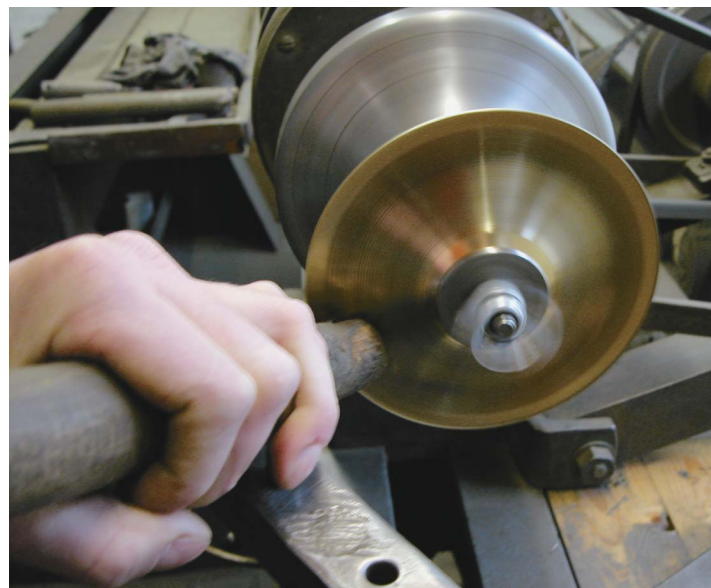
Runde Sache: Mit einem Holzhammer wird der Anstoß auf einer Stange zu einem konischen Rohr gebördelt
