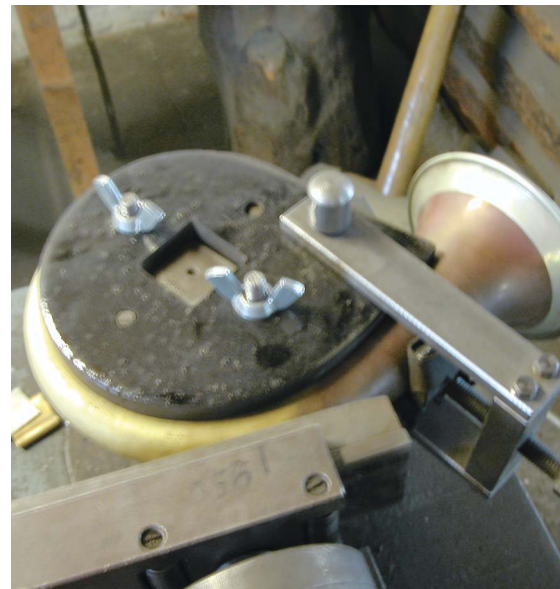
Biegen: Das bereits mit Blei eingegossene Schallstück wird in einer Biegemaschine in Form gebracht
