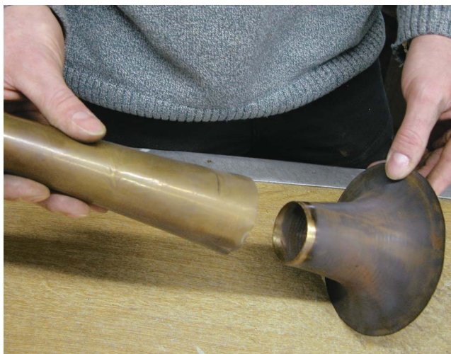
Zusammensetzen: Der Schallbecher wird mit dem Anstoß hart verlötet, so dass später fast keine Naht mehr zu sehen sein wird
