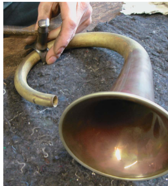
Beulenfrei: Kleine Unebenheiten werden mit einem Hämmerchen geglättet. Wenn alles perfekt ist, wird das Blei wieder aus dem Schallstück herausgeschmolzen
