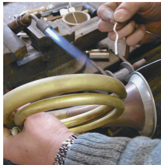
Aus drei mach eins: Schallstück und bereits fertig geformter Anstoß werden zusammen gelötet. An das Anstoß-Ende kommt dann der Stimmzug
